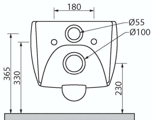
N.B.: Le misure indicate possono subire una variazione dello 0,8 % circa, dovuta ad usura degli stampi o a piccole variazioni delle caratteristiche tecniche relative alle materie prime che compongono l'impasto.
